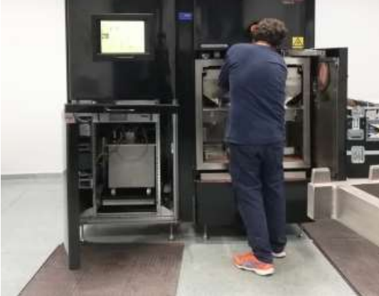
Procesado de Cobre puro por EBM
