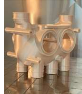
Ducto de ventilación Equipo Electrónico ULTEM®9085
