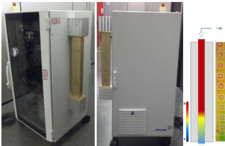
KORA reactor microondas laboratorio e industria de radiación homogénea
