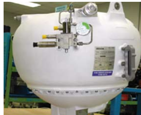
Figura 7.- Depósito hidráulico del A380
