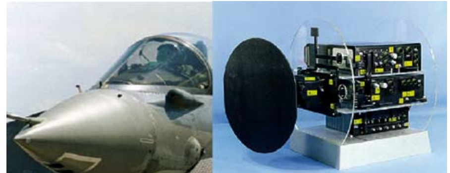
Figura 18. - Radar del Eurofighter (CAPTOR)
