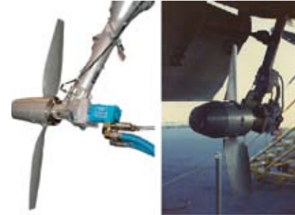
Figura 14.- RAT del A380 y Boeing 757
